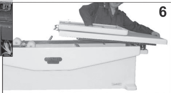
Фото 8. Снятие секций кушетки при техническом обслуживании
