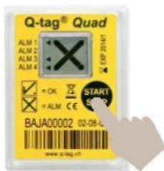
Q-tag® Quad может быть остановлен, по окончании транспортировки груза, (например, когда осуществлена поставка до конечного пункта назначения). Для этого, START / STOP-кнопка должна быть нажата в течение 2 секунд. Мигающая точка исчезнет. **V** (ОК символ) или **X** ( символ тревоги) будет отображаться на экране в течение не менее 3-х месяцев.
