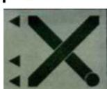
отображается во время нормальной работы до тех пор, пока сигналы тревоги не был зафиксирован.
