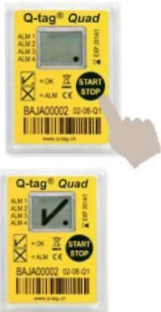
Устройство активируется нажатием кнопки START / STOP в течение 2 секунд.
