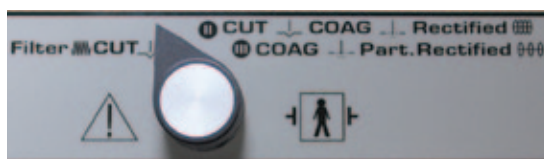
Рис. 18. Переключатель рабочих режимов в положении «FILTER/CUT» - «РАЗРЕЗ»
