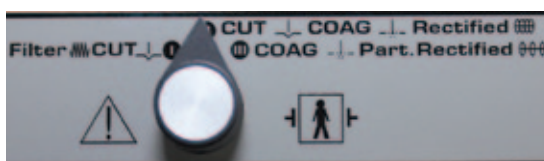
Рис. 19. Переключатель рабочих режимов в положении «CUT/COAG/RECTIFIED» - «РАЗРЕЗ/КОАГУЛЯЦИЯ»
