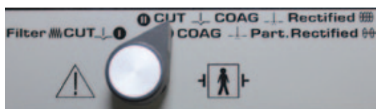
Рис. 20. Переключатель рабочих режимов в положении «COAG/PART.RECTIFIED» – «КОАГУЛЯЦИЯ», «FULGURATE» – «ФУЛЬГУРАЦИЯ» и БИПОЛЯРНАЯ КОАГУЛЯЦИЯ
