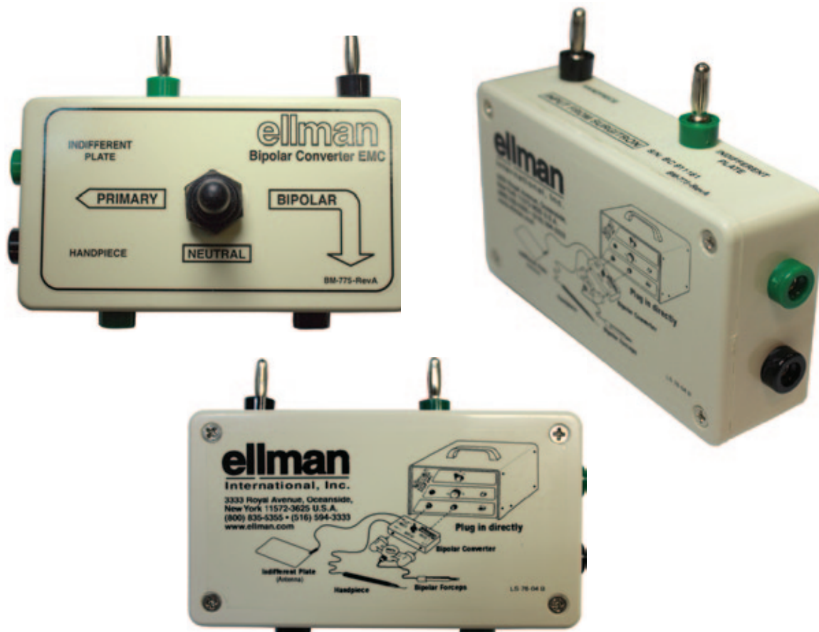
Рис. 41. Биполярный преобразователь (Адаптер EMC-H95A) для прибора портативного для электро-радиохирургии «Сургитрон» Вверху слева – вид сверху. Вверху справа – вид сбоку. Внизу – вид снизу.
