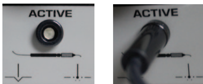
Рис. 23. Гнездо для подключения монополярного наконечника-держателя.
